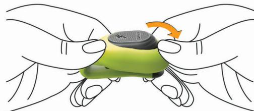
2 Uvolněte kryt ① na zadní straně snímače otočením proti směru hodinových ručiček.
