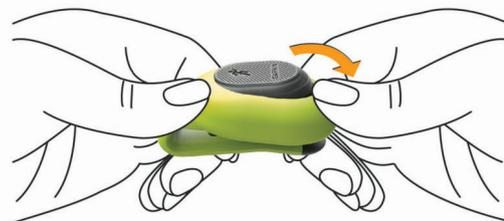
2 Zakrenite poklopac ① sa stražnje strane senzora u smjeru suprotnom od kazaljke na satu kako biste ga otključali.
