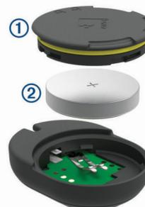
3 Ta av dekselet, og ta ut batteriet ②.
