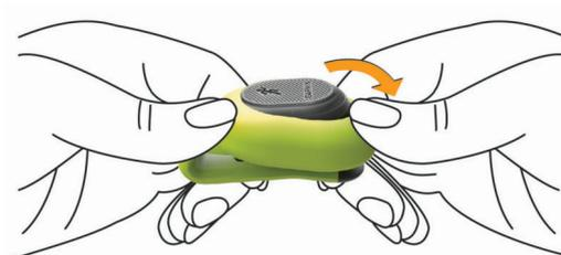
2 Przekręć w lewo pokrywkę ① na tylnej części czujnika, aby ją otworzyć.
